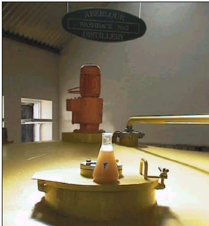
Exempel på ett slutet jäskärl. Motorn driver den roterande armen.
