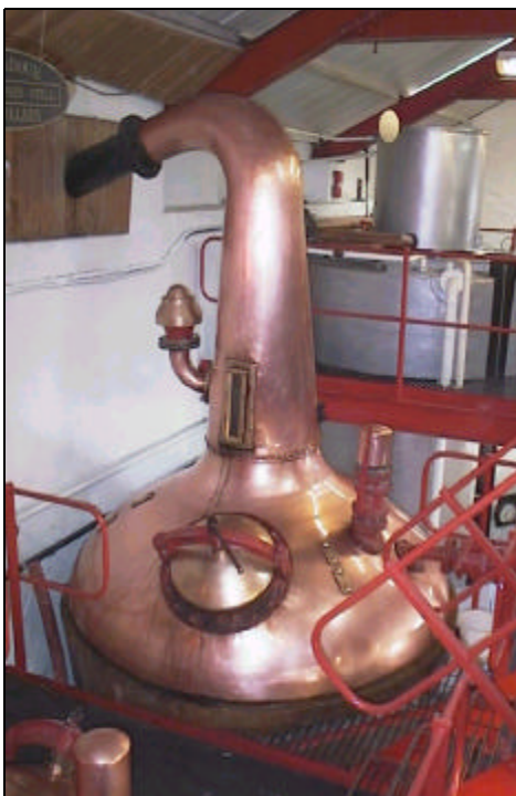
Mindre svagspritspanna på Edradour distillery.
